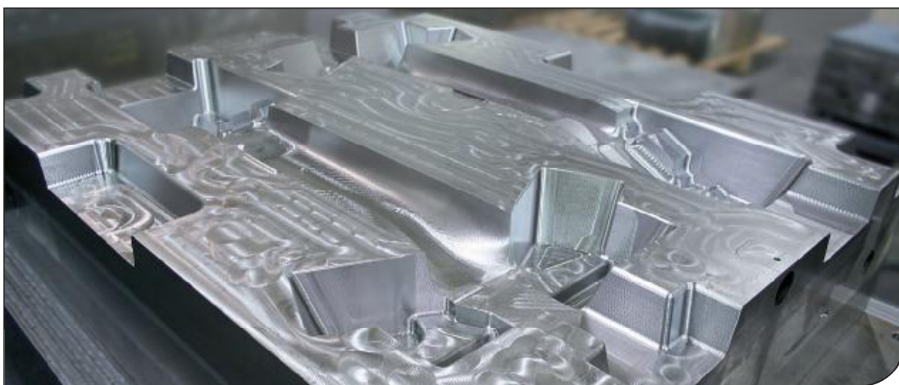
I cicli di superfinitura permettono di ottenere superfici particolarmente belle e lisce. (società Aalbers, Stati Uniti).
